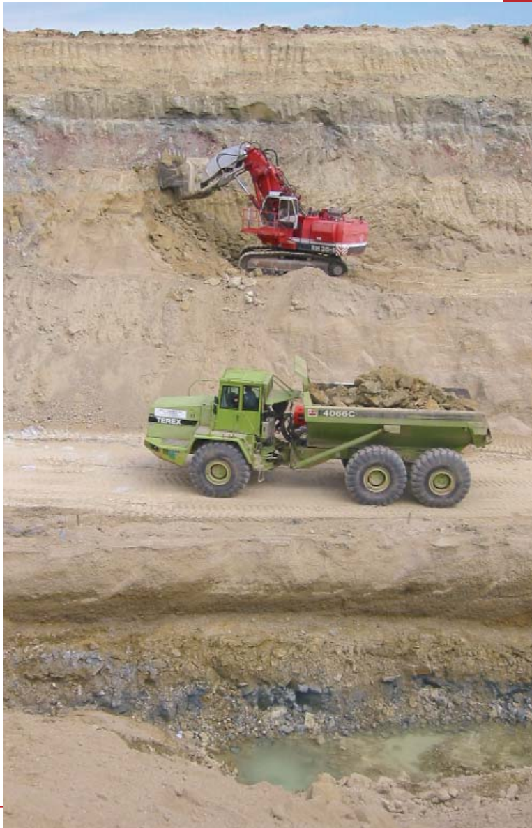
Abraumgewinnung über Bentonit durch die Fa. Südchemie bei Landshut/Bayern
