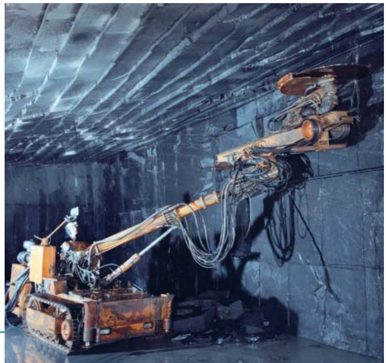
Untertägige Dachschiefergewinnung in Mayen (Rheinland-Pfalz) durch die Fa. Rathscheck Schiefer
