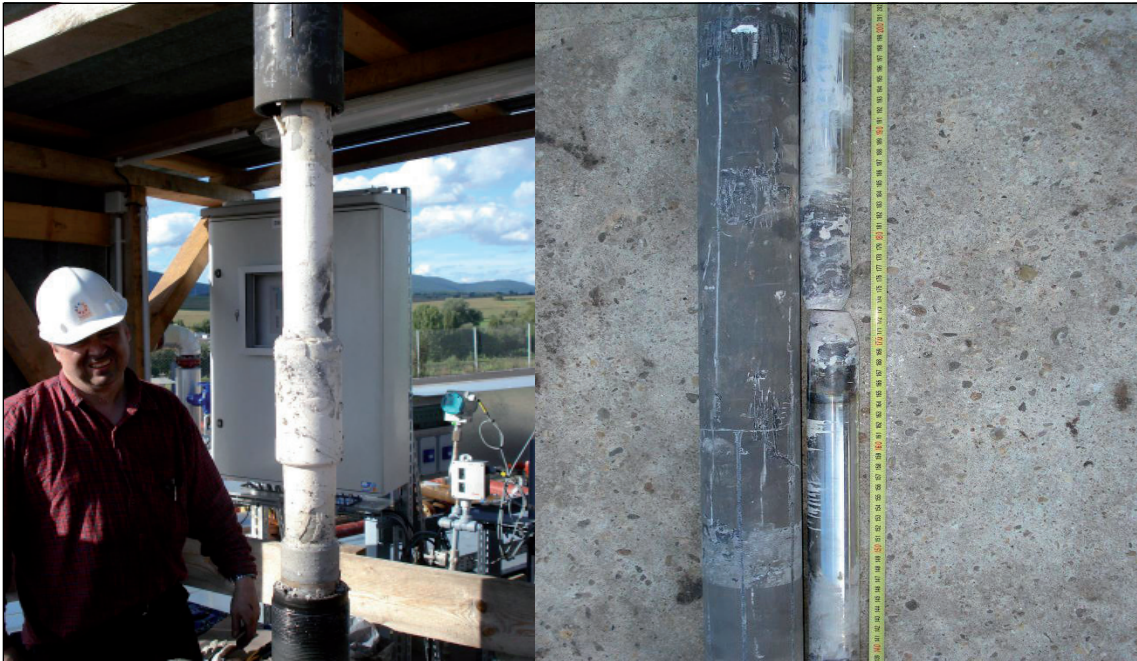
Abb. 44: Karbonatablagerungen entlang des Gestänges (links) und Bruch der Antriebswelle im oberen Bereich im August 2008 (rechts).
