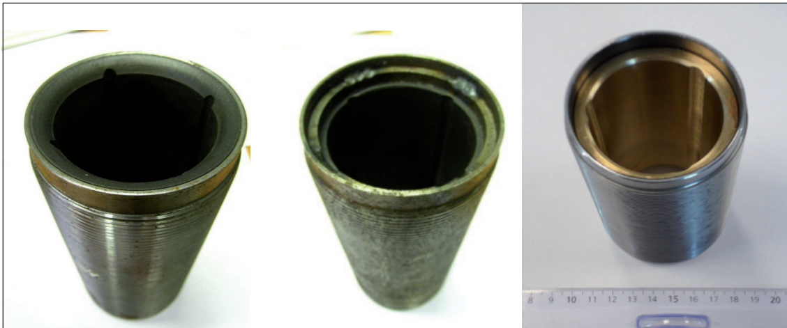
Abb. 49: Gleitlager zur Führung der Antriebswelle, links: Gusseisen, Mitte: Teflon, rechts: Kupfer.
