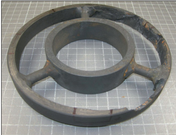
Abb. 48: Durch Korrosion beschädigte Zentriervorrichtung.
