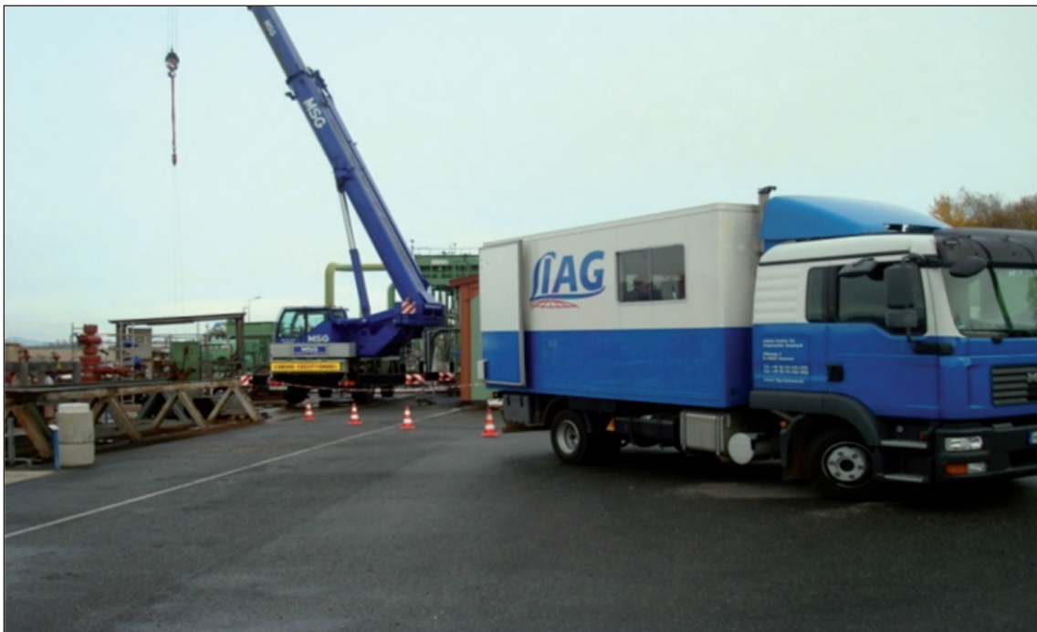
Abb. 12: LIAG-Messwagen bei der Temperaturmessung in der Bohrung GPK2.
