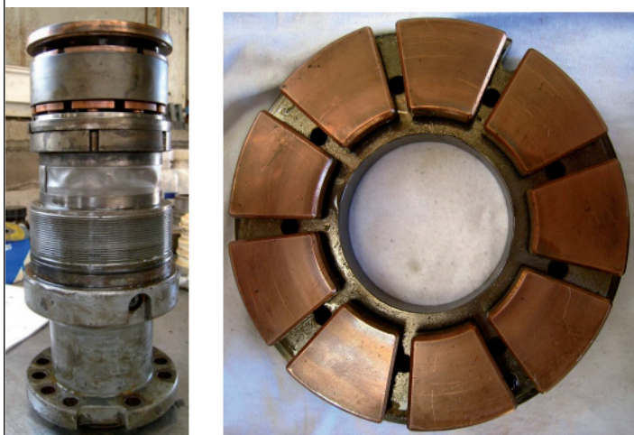
Abb. 53: Mechanischer Anschlag des Protectors (links) und Detail eines der Bronzelager (rechts).
