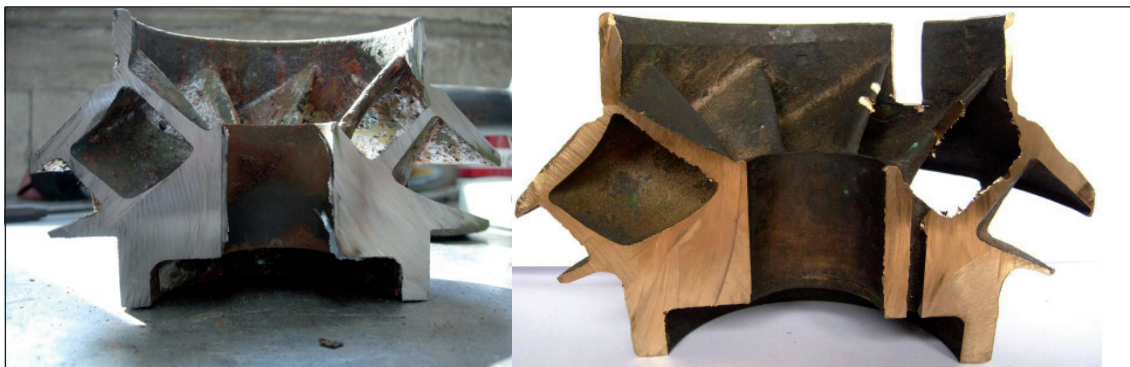
Abb. 47: Innenansichten eines zerschnittenen Impellers (Flügelrad) aus Gusseisen (links) und aus Bronze (rechts).
