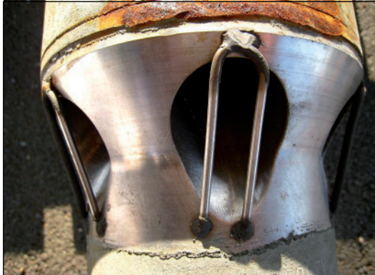
Abb. 51: Ansicht der Saugseite der Förderpumpe aus 25 Cr-Duplex.
